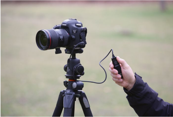
Beispiel für einen Kabelfernauslöser. Die preisgünstigen Geräte brauchen keine Batterien.
